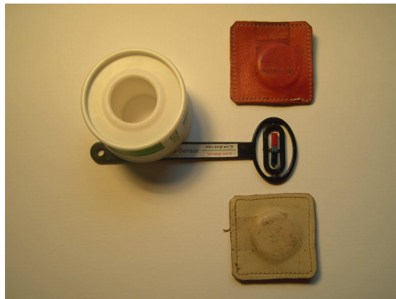
Bild 4: Zwei Magnete mit Magnetfeldsensor zur Bestimmung der Polarität
